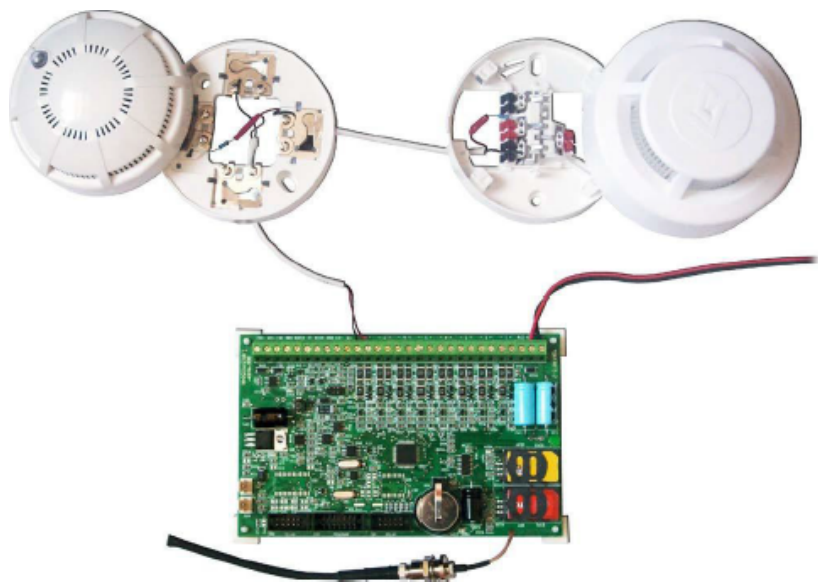
Рисунок 46. Фотография подключения двух пожарных датчиков
