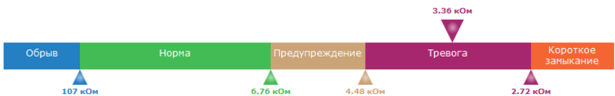
Рисунок 18. Шкала порогов пожарного шлейфа
